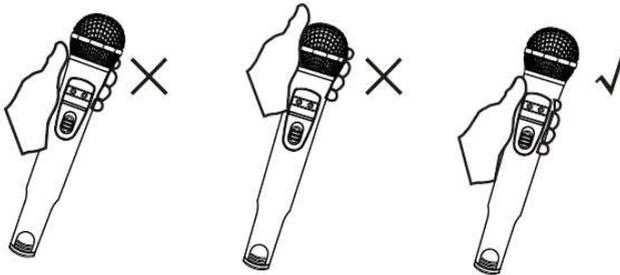
2. Evite sujetar el micrófono por la zona de la antena.
